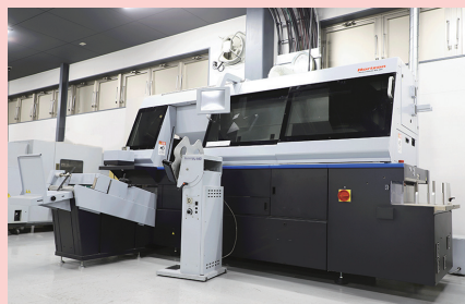
ホリゾン無線綴じ機
