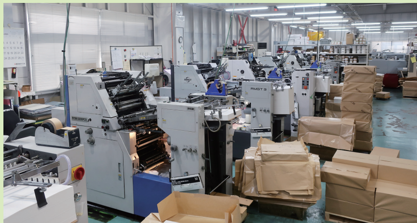
大阪本社工場の小型オフセット印刷機
